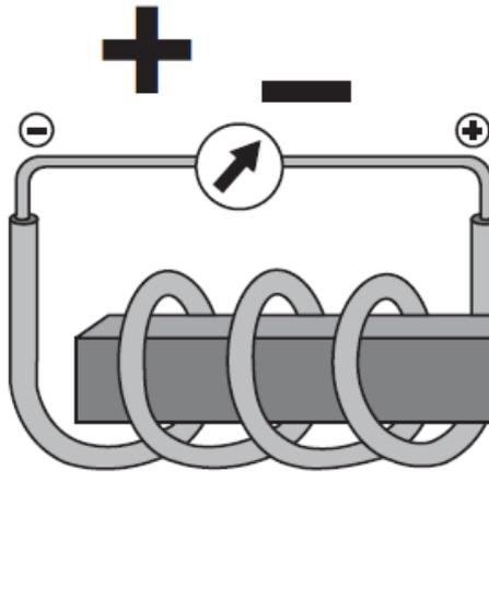
Sobald ein Magnet in einer Kupferdraht-Spule bewegt wird, entsteht elektrische Spannung. Der Zeiger des angeschlossenen Messgeräts schlägt aus und zeigt diese an.
