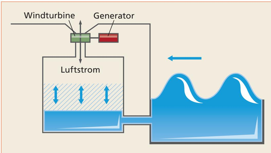
**Aufgabe:** Beschreibe den abgebildeten Vorgang der Stromerzeugung durch ein Wellenkraftwerk kurz mit eigenen Worten.
