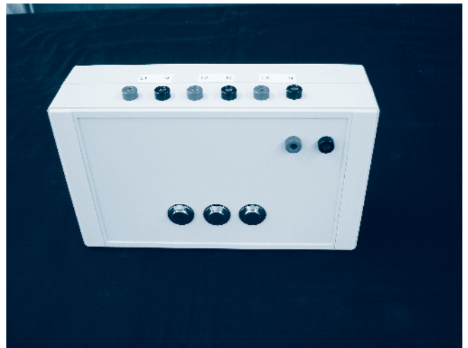
Box mit Tastschaltern zur manuellen Ansteuerung der Spulen
